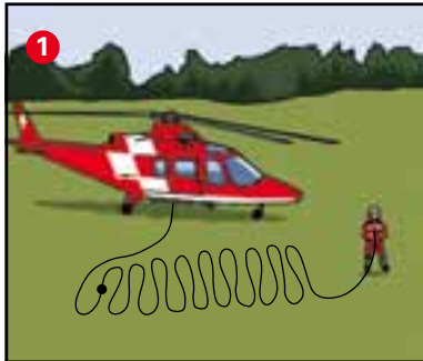
Das lange Seil ist am Lastenhaken des Helis befestigt und liegt säuberlich ausgelegt am Boden. Der SAC-Retter klinkt sich am Seilende ein.
