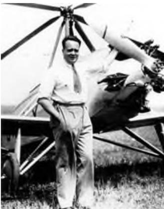
Ein weiterer Schritt in der Entwicklung des Helikopters führt über den Spanier Juan de la Cierva. Er erfindet den Traghubschrauber und entdeckt damit als Erster die Möglichkeit der Autorotation: Die Rotorblätter werden bei seinem Modell „Autogiros“ nicht starr, sondern mit Schlaggelenken am Rotorkopf befestigt. Sie passen sich so der Luftströmung an und machen einen stabilen Geradeausflug möglich. Als erster Pilot überquert Cierva mit seinem Drehflüglerflugzeug 1928 den Ärmelkanal.
